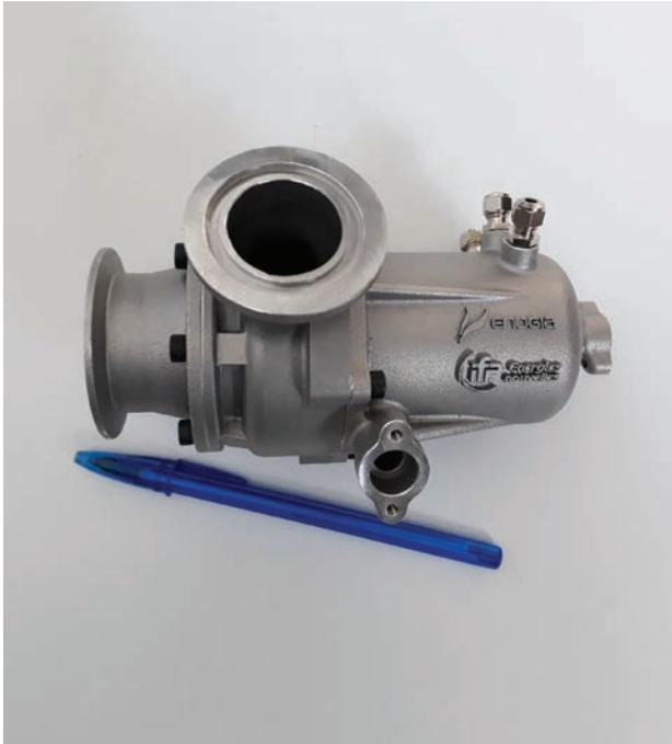
Turbopompe-génératrice ORC (48 V) pour application véhicules légers
